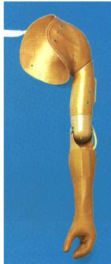
Hybridprothese mit myoelektrischer Hand und zuggesteuertem Ellbogengelenk
