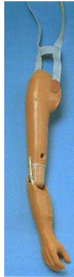
Myoelektrische Prothese mit myoelektrischer Hand und myoelektrisch gesteuertem Ellbogengelenk
